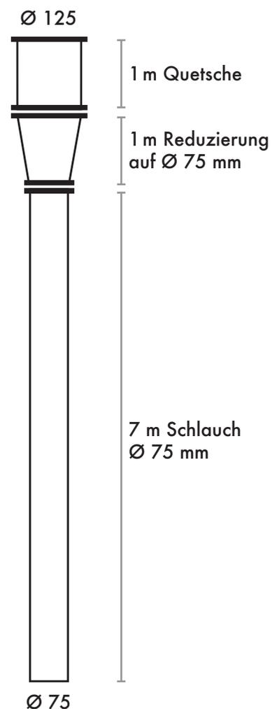
Der handgeführte Endschlauch darf während des Betoniervorgangs eine max. Länge von 4 Metern zwischen Reduzierung und Schalung nicht überschreiten. Ansonsten muss der Endschlauch getauscht werden.
