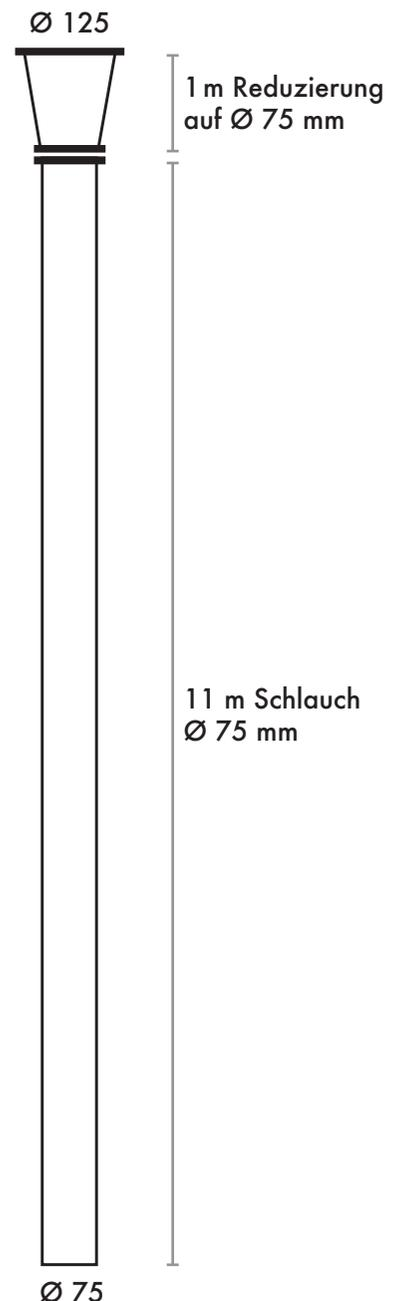
**Der handgeführte Endschlauch darf während des Betoniervorgangs eine max. Länge von 4 Metern zwischen Reduzierung und Schalung nicht überschreiten. Ansonsten muss der Endschlauch getauscht werden.**
